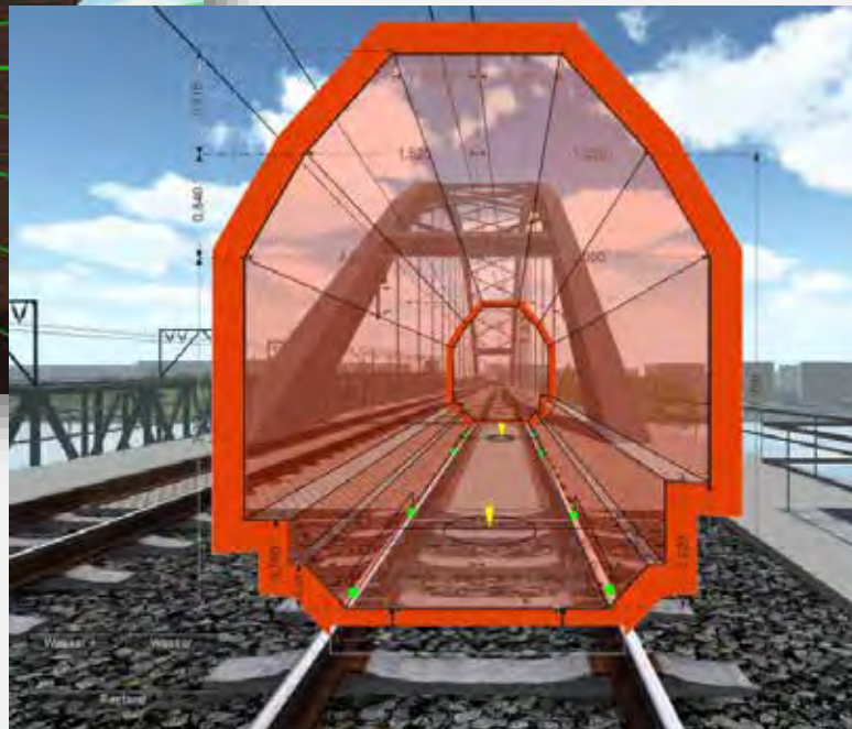
Trassenführung und Lichtraumprüfung
